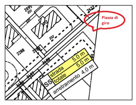
Per la realizzazione di questa piazza di giro, nonché per regolare la larghezza del campo stradale conformemente al Piano regolatore, si rende necessario l'acquisizione di una parte del fondo part. no. 145 (questo fondo è stato unificato con il fondo no. 146).
