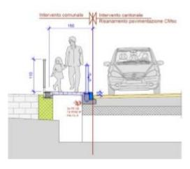
Il progetto del nuovo manufatto pedonale è completato dalla posa di una barriera di protezione in acciaio zincato (a correnti verticali) sul lato Sud dello stesso per impedire la caduta in corrispondenza del riale proveniente da Sud (zona Madonna della Fontana).
