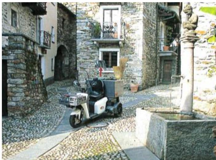
Questo veicolo permette un carico utile di 270 kg e la batteria ha un'autonomia di percorrenza di 130 km.
